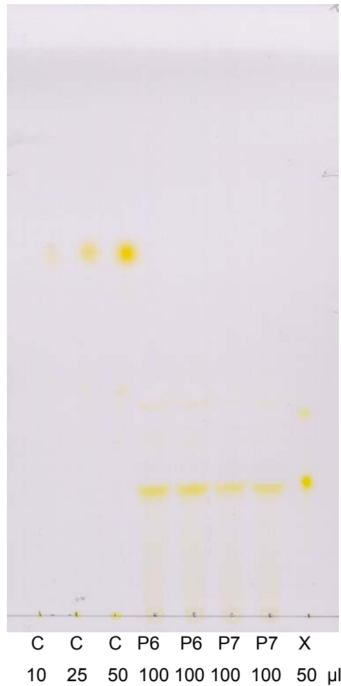
Abb.6: Bild einer DC- Platte: C: \beta - Carotin- Standard 0,99mg/100mlPetrolether ,X: Xanthophyll-Standard (alt) 0,2mg/20ml Petrolether,P6: Dinkelmuster Baden Württemberg Gold Anbaugebiet Neuhof, P7: Dinkelmuster Frankenkorn, Anbaugebiet Gadegast
